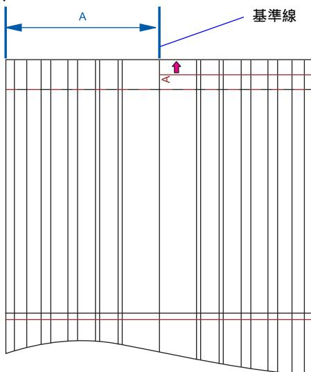
7. 寸法 (A) の長さを「露光センター補正1」に入力します。
