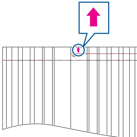
14. テストプリントの測定寸法(A)がペーパー幅の半分になっているか確認します。
