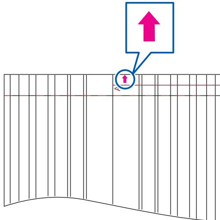
6. テストプリントの左端から基準線までの寸法 (A) を測定します。
